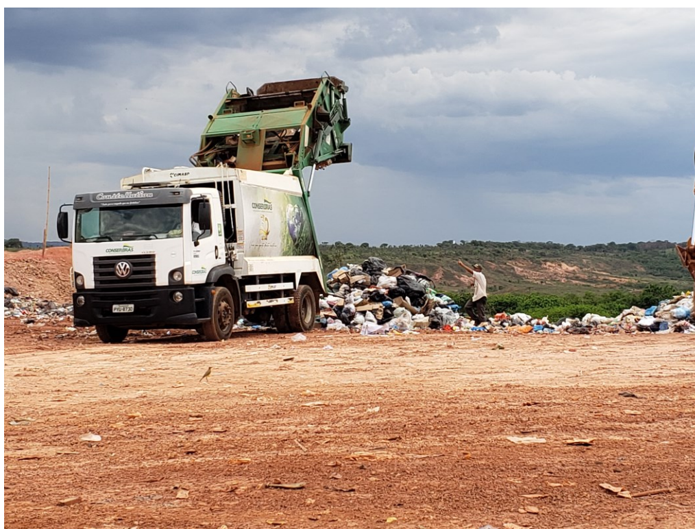
FIGURA 5 – CAMINHÃO COMPACTADOR REALIZANDO A DESCARGA DA COLETA DOS RESÍDUOS SÓLIDOS, NO ATERRO SANITÁRIO DE PATOS DE MINAS.
